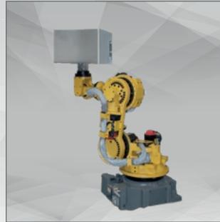
6-Achsen Kurzarm-Roboter zum vollautomatischen Schleifen und Handling von Teilen mit Rundungen
