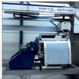
Handling von großen und schweren Bauteilen mittels 3D-Manipulator
