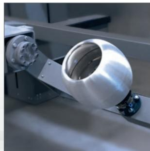
Drehvorrichtung für das Bearbeiten von rotations-symmetrischen Werkstücken
